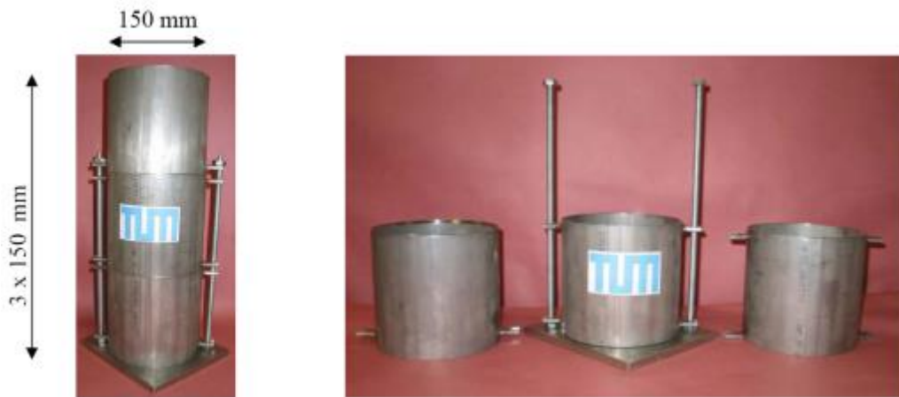
Bild 18: 3-teiliger Sedimentationszylinder (Münchener Variante)
