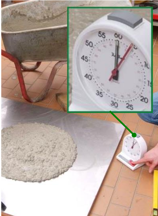
Bild 13: Bestimmen von der Zeit t_{500} im Setzfließversuch [Lit 12]
