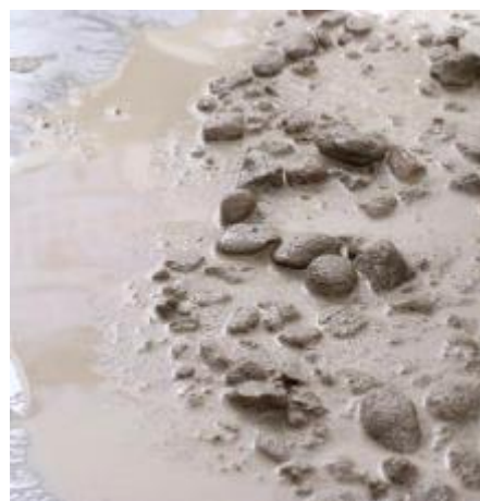
Bild 12: SVB mit gutem Zusammenhalt (links) und abgesetzter Körnung sowie Ring aus Leim/Mörtel (rechts) [Lit 12]
